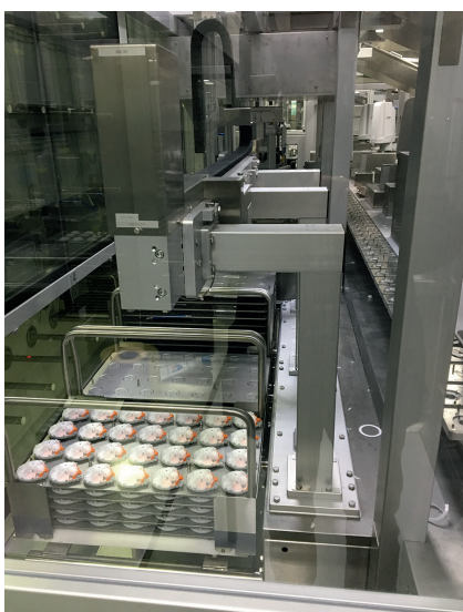
Bild 1. Die Inhalatoren werden vollautomatisch im Reinraum montiert (© Witoska)
